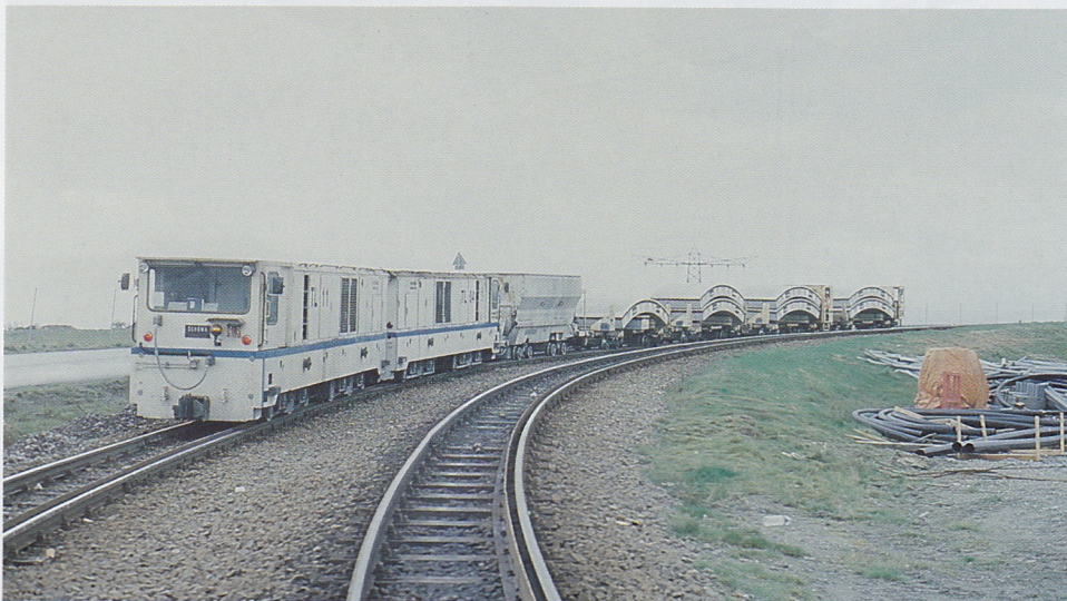
Locomotieven TL11 en TL04 duwen een volbeladen trein naar de westelijke tunnelbuis; 6 november 2001. Foto: Gerard de Graaf.
