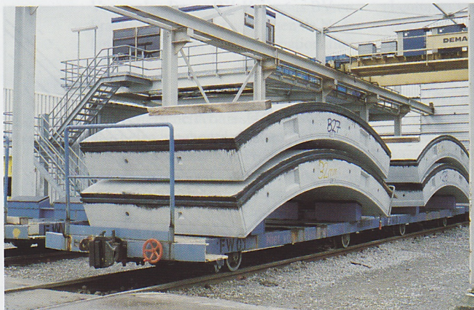
Wagen FW01 wordt uitsluitend gebruikt voor vervoer tussen betonfabriek en tasveld. Terneuzen, 6 november 2001. Foto: Gerard de Graaf.
