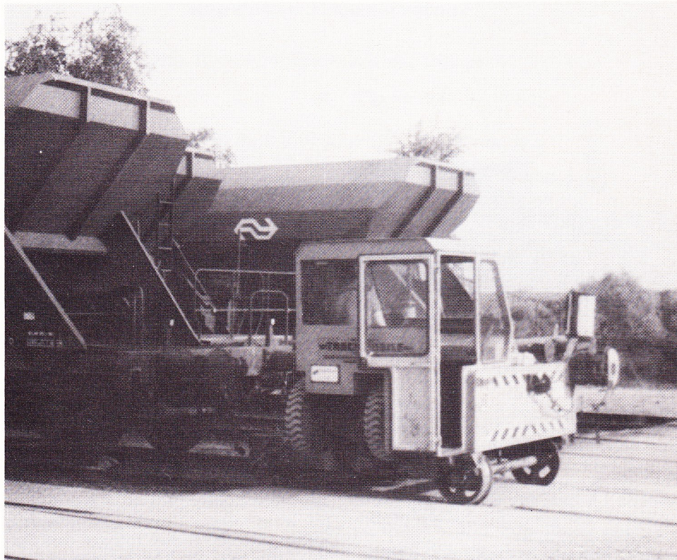
De Trackmobile van de Grindery Linne op de rails. De kleine spoorwijdte van de weg-achterwielen komt op deze foto goed uit. Linne; 30 juli 1984.
