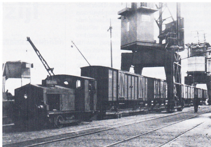
Een trein, bestaande uit de O&K-motorloc, een rolwagen met een EDS-vierasser en drie rolwagens met elk twee OG-tweeassers op de kade in Delfzijl; 14 juli 1938. Foto: W.D.J. Cramer (119.309).
