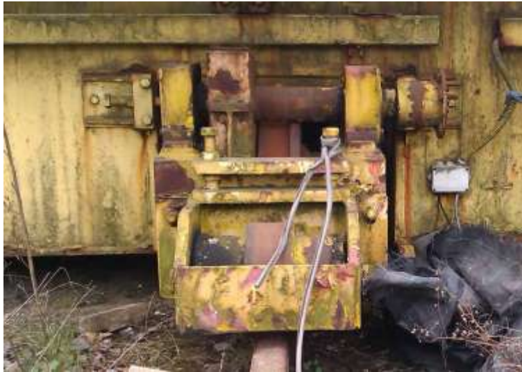
Aangedreven wiel, rechts de aandrijfaskoppeling, de Cardanas is verwijderd (foto GJ)
