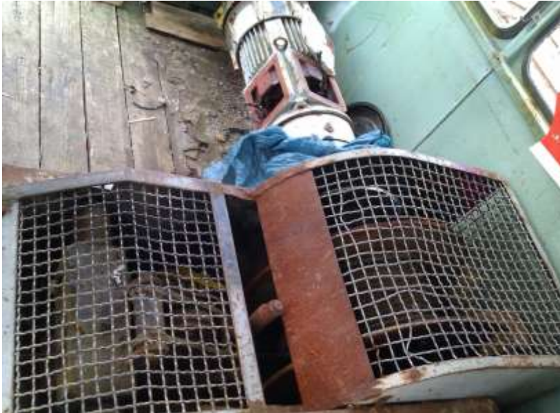
Electrisch gedreven lier met draadspoelinrichting en bescherming op Brug 2 (foto GJ)
