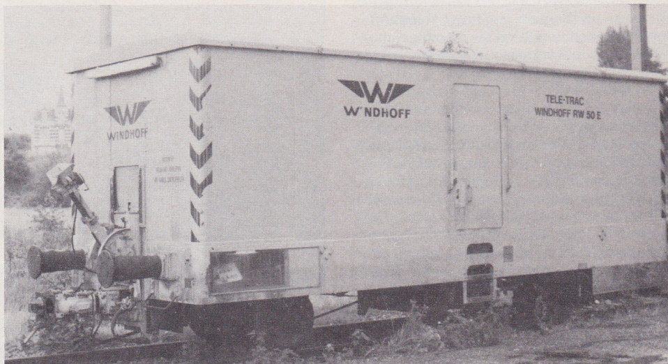
De Windhoff-Tele-Trac van de wasinstallatie in Nijmegen; 17 augustus 1985. Achter het plexiglas boven de vooras bevindt zich het bedieningspaneel voor de koppelingen, die door een TL-balk verlicht kunnen worden. Foto: H.J. Kolkman.
