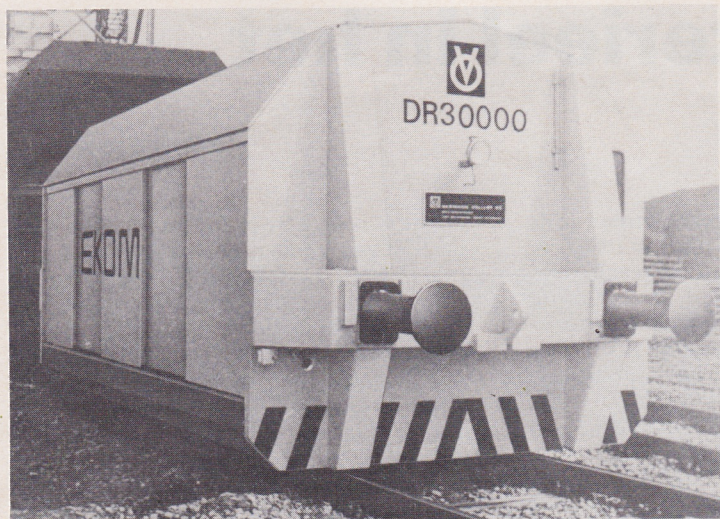
De rangeerrobot van EKOM op de Maasvlakte, kort na de aflevering in 1977. De afmetingen van deze vierasser zijn slechts 8 × 3 × 3 m 3 . Foto: Vollert.
