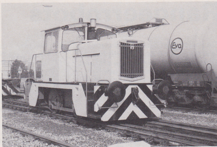
De enige particuliere English Electric-locomotief in Nederland bij AKZO Zout Chemie. Delfzijl, 10 maart 1986. De koppelstangen doen niet vermoeden, dat de locomotief dieselelektrisch door een 350 pk Perkins-diesel wordt aangedreven. Foto: H.J. Kolkman.
