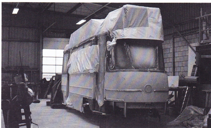
De A-bak van de Amsterdamse 618 in herstel van aanrijdingschade bij de firma Cranen te Heeswijk-Dinther, voordat deze met de C-bak van de 620 en de B-bak van de 608 weer in dienst kwam; 18 januari 1994. Foto: André van der Smaal.
