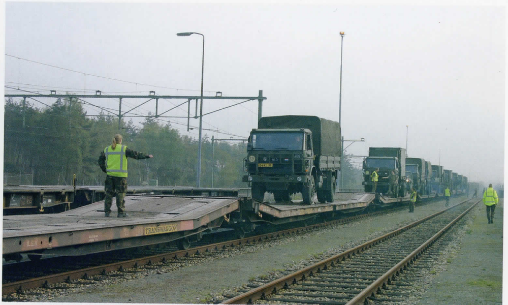
Bij het laden en lossen van rollend materieel helpt een gids de bestuurder van het voertuig door hem via handgebaren over het midden van de wagen type Laads te loodsen. 't Harde, 14 april 2009.
