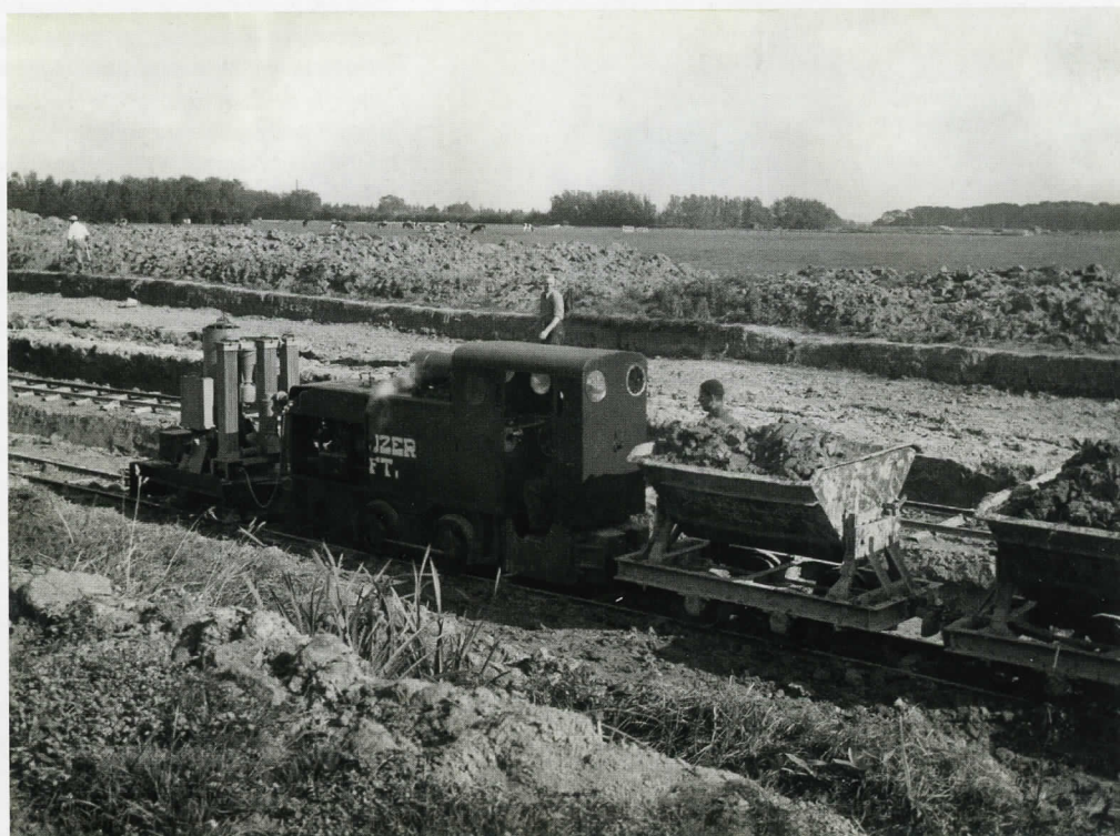
Dat een gasgenerator op een losse eenassige lorie in de praktijk werkte, bewijst deze foto van een andere Deutz MLH 322 G, die in het najaar van 1940 op een onbekende plaats aan het werk is met SIJ-kipwagens. Foto: Spoorijzer, Collectie: Gerard de Graaf.
