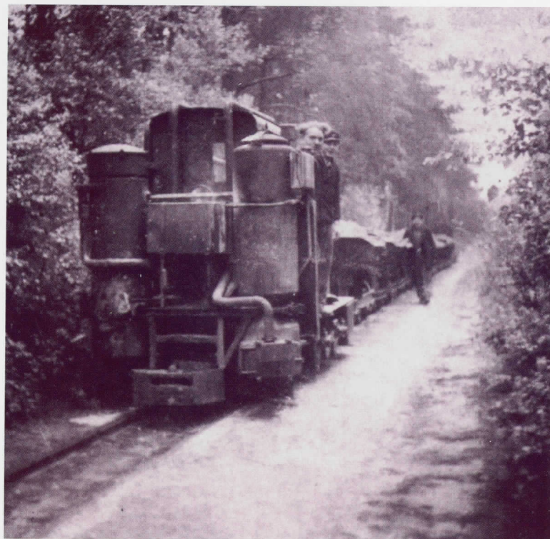
Dakpannenfabriek Janssen-Dings in Belfeld had een Deutz OME 117F (600 mm) waarschijnlijk bij Spoorijzer laten ombouwen. Het leidde tot een imposante verschijning in de Limburgse bossen. Belfeld, circa 1943. Foto: Collectie: Twan Ernst.
