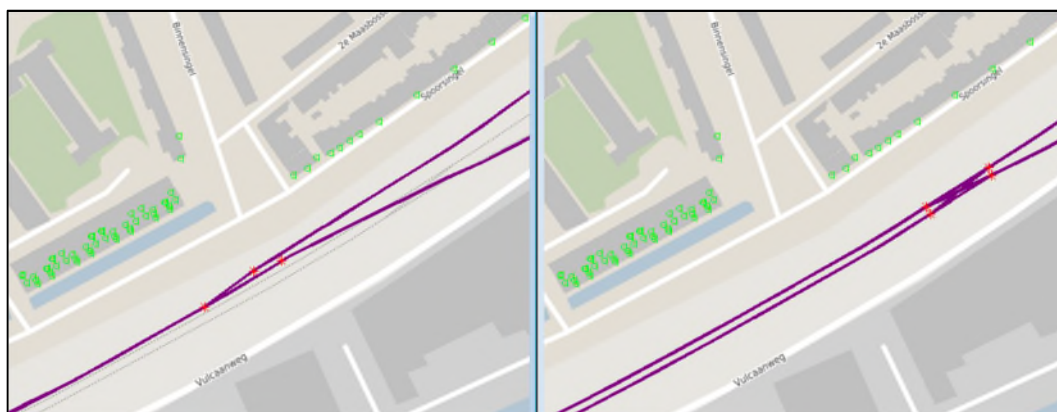
Figuur 8 Ligging wissels (rode asterisken); links: situatie vóór realisatie emplacement; rechts: situatie na ingebruikname emplacement
