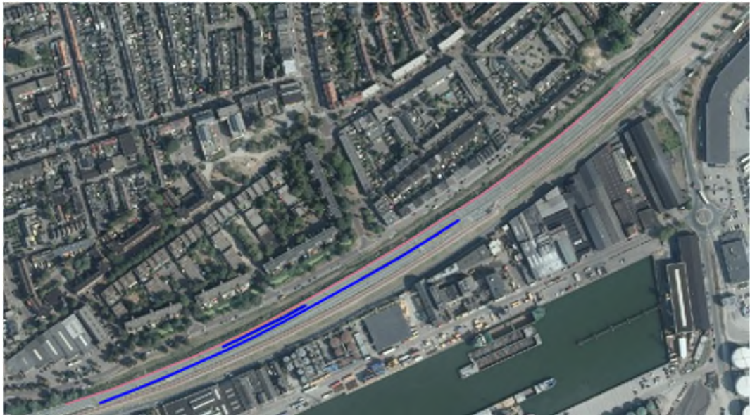
Figuur 10 Overdrachtsmaatregel middellang middenbermscherm 0,9 m blauwe lijn (variant 03). De bruine lijn betreft bestaand scherm.
