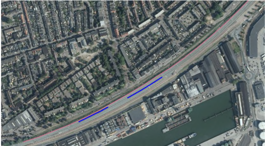
Figuur 9 Overdrachtsmaatregel kort middenbermscherm 0,9 m blauwe lijn (variant 02). De bruine lijn betreft bestaand scherm.
