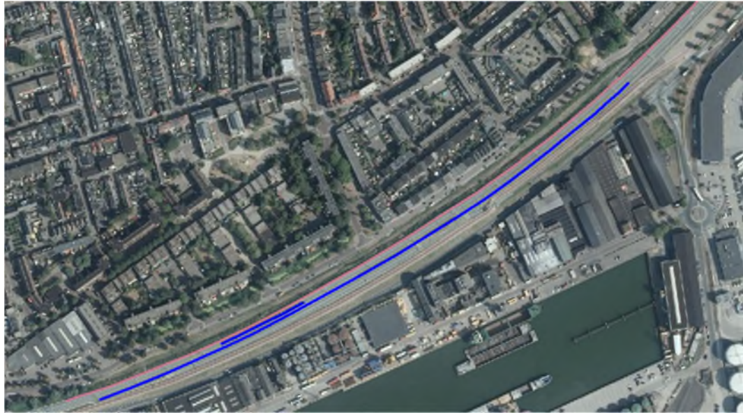
Figuur 11 Overdrachtsmaatregel lang middenbermscherm 0,9 m blauwe lijn (variant 04). De bruine lijn betreft bestaand scherm.
