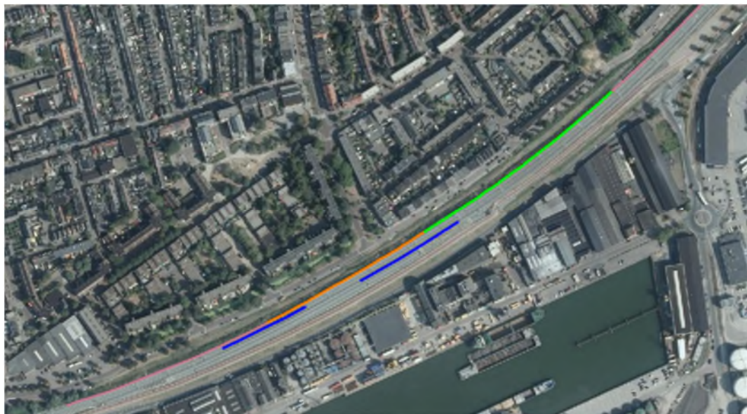
Figuur 12 Overdrachtsmaatregel kort middenbermscherm 0,9 m blauwe lijn in combinatie met ophoging/vervanging scherm (variant 08). De oranje lijn geeft een schermhoogte van 4 m weer. De groene lijn een hoogte van 3,5 m. De bruine lijn betreft bestaand scherm.
