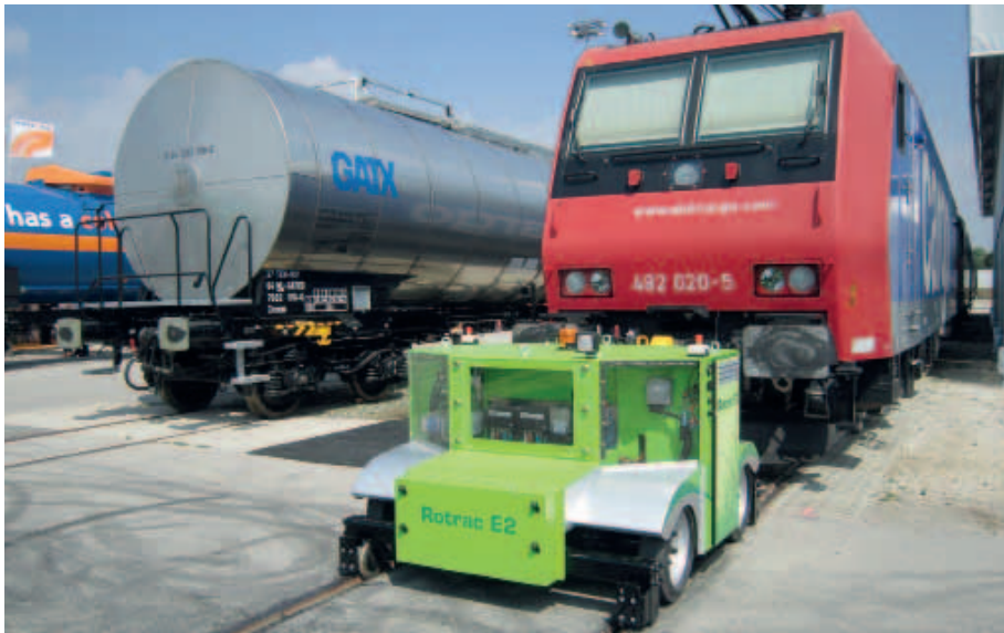
Abb. 1: Trotz der äußerst kompakten Abmessungen bringt der Rotrac E2 eine hohe Zugkraft für Züge bis 250 t auf die Schiene.
