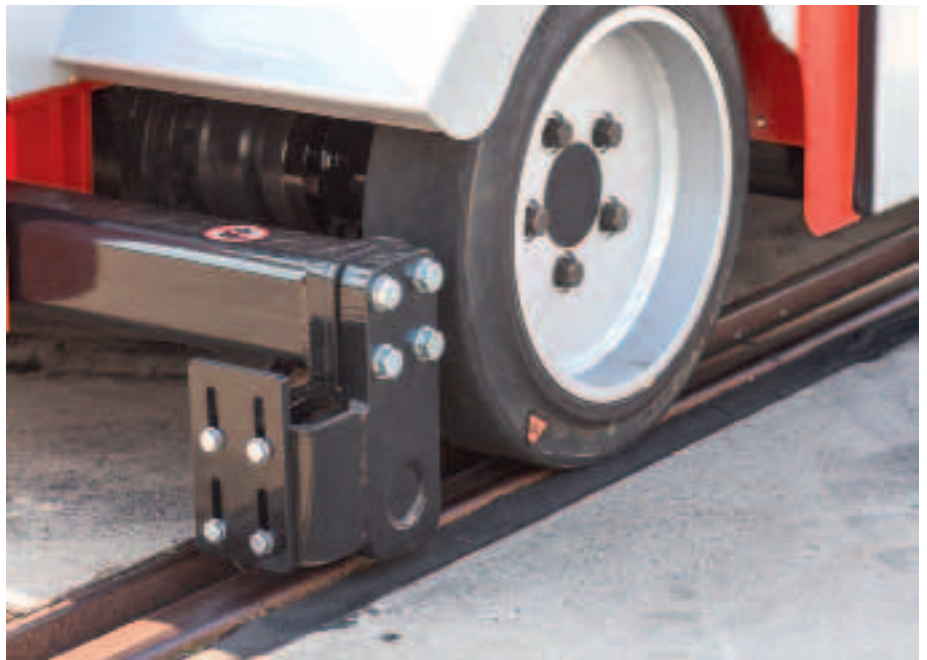
Abb. 2: Die hydraulisch verstellbare Schienennachführung gewährleistet einen gleichbleibend hohen Anpressdruck der Räder auf der Schiene.
