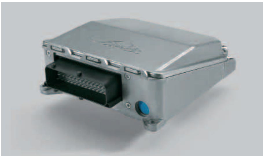
Abb. 5: Alle Antriebsfunktionen werden über die zwei elektronische Linc-Steuerungen koordiniert, die im Master-Slave-Modus arbeiten.
