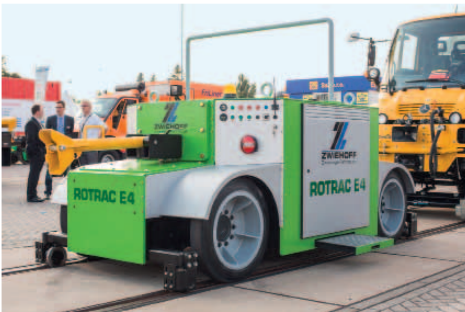
Abb. 6: Der Rotrac E4 weist gegenüber dem E 2 eine verdoppelte Zugkraft auf. Fotos: Linde Material Handling
