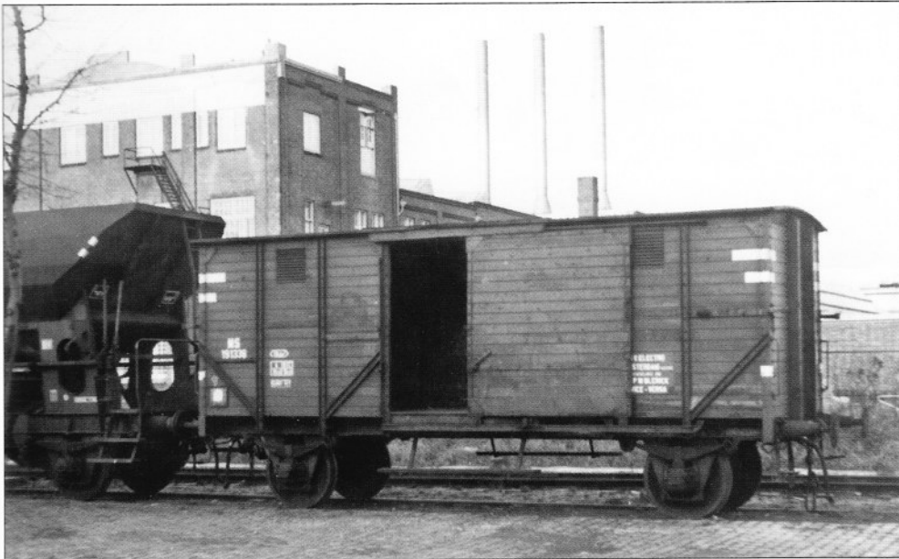
Gesloten goederenwagen NS 191338 op het emplacement aan de Distelweg, 26 december 1967. De wagen draagt het opschrift N.V. Electro Amsterdam. Mogelijk werd deze wagen als schutwagen gebruikt bij het rangeren van treindelen op de spoorpont. Jan van Huijsloot
