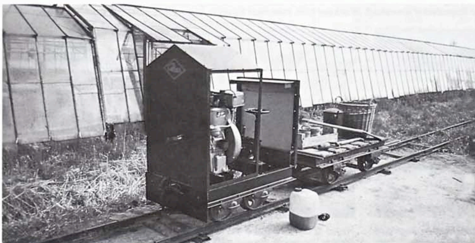
Zelfgebouwde motorlocomotief met eencilindermotor type Petten rijdend op een spoorwijdte van 500 mm. Bruchem, 28 april 1998. Foto: Henk Sluijters.
