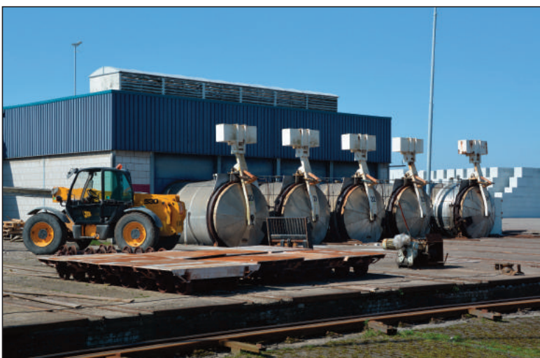
De autoclaven zijn alle bereikbaar via een traverse. Hillegom, 4 april 2017. Foto: Gerard de Graaf.
