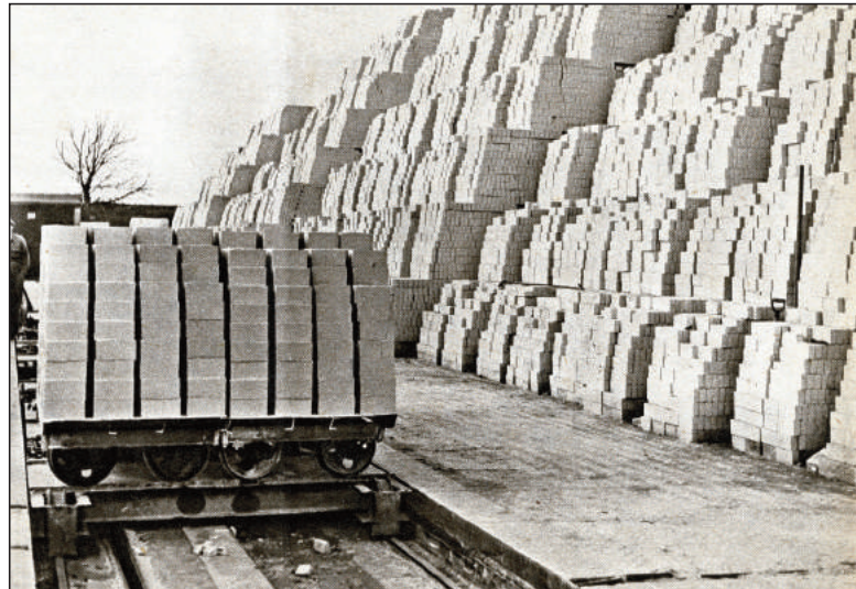
Aanvoer van kalkzandstenen naar het tasveld, waar een grote hoeveelheid klaar ligt voor de verkoop. Foto: De Spiegel, 1952.
