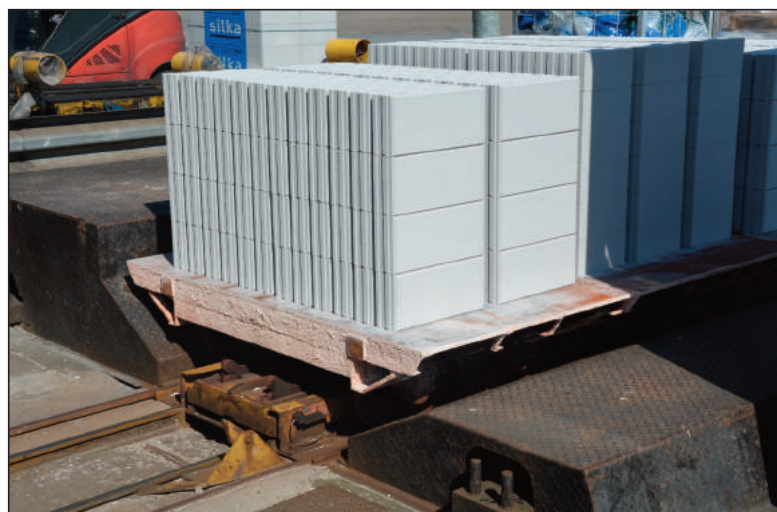
Plateauwagens met uitgeharde stenen. Onder de wagens op eigen baan de 'ophaler' die de wagens in en uit de autoclaven rijdt. Foto: Gerard de Graaf.
